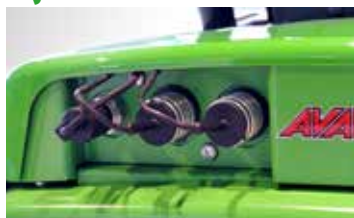
Tomas traseras hidráulicas
